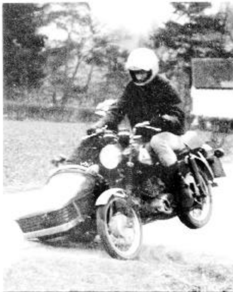
Bild 45: Die Seitenwagennase schleift schon auf der Erde. Meistens überschlägt sich das Gespann in einer solchen Situation.
